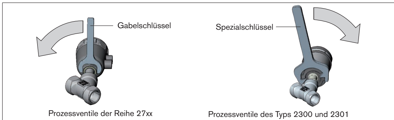
Bild 22: Vorgeschriebene Drehrichtung und Werkzeug für das Drehen des Antriebsmoduls
