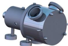
Die volumetrischen Pumpen mit sinusförmigem Rotor eignen sich besonders zum sanften Fördern ohne Quetschen von viskosen und scherempfindlichen Produkten, die sensible Feststoffe enthalten.
