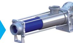
Die Exzentrerschneckenpumpen eignen sich besonders zum Fördern von Medien mit niedriger als auch hoher Viskosität, sowohl Feststoff beladen selbst mit abrasiven Bestandteilen als auch für besonders empfindliche Produkte. Die schonende gleichmäßige Förderung der Pumpe ist nahezu pulsationsfrei und proportional zur Drehzahl regelbar. Sie besitzt eine hohe Saugleistung und kann gleichzeitig Drücke bis zu 24 bar bei einer max. Fördermenge von 270 m<sup>3</sup>/h erreichen.
