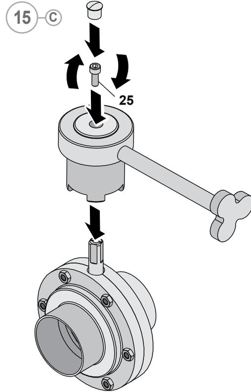
**15SCHEIBENVENTIL MIT HANDANTRIEB VVF WAFER4**
