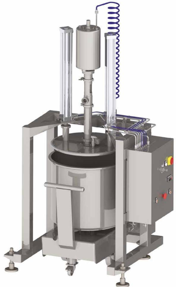
Station mit pneumatischem Doppelkolben für Behälter mit einem Durchmesser von mehr als 700 mm, einschließlich pneumatischer Kolbenpumpe und Abstreifplatte. Für Teige, Marmelade, Creme usw. ... die nach der Verarbeitung umgefüllt werden müssen.
