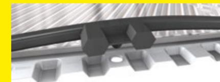
Kelvion-Dichtungen passen perfekt zu unseren Platten, um einen sorgenfreien Betrieb zu gewährleisten. Unsere abgechrägte Öffnung ermöglicht das Einrasten der einzelnen Dichtungen und verhindert, dass die Verriegelungslasche durchtrennt wird. Dichtungen können beim Schließen einfach ohne Werkzeug oder Klebstoff und selbstsitzend montiert werden. Das Auswechseln einer Dichtung dauert nur wenige Sekunden und macht die Wartung schnell und einfach.
